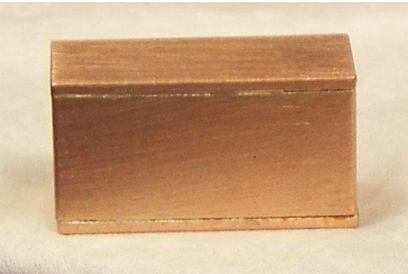
Cu clad target (0.127 cm Cu)
